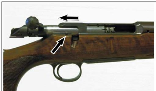
Fig. 8 // Desmontar cámara
