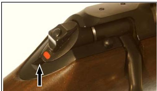
Fig. 4 // Indicatore d'armamento, disarmato, sbloccato
