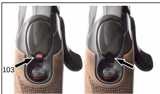
Abb. 8, Spannanzeige 103 der Kammer (links: gespannt, rechts entspannt)
