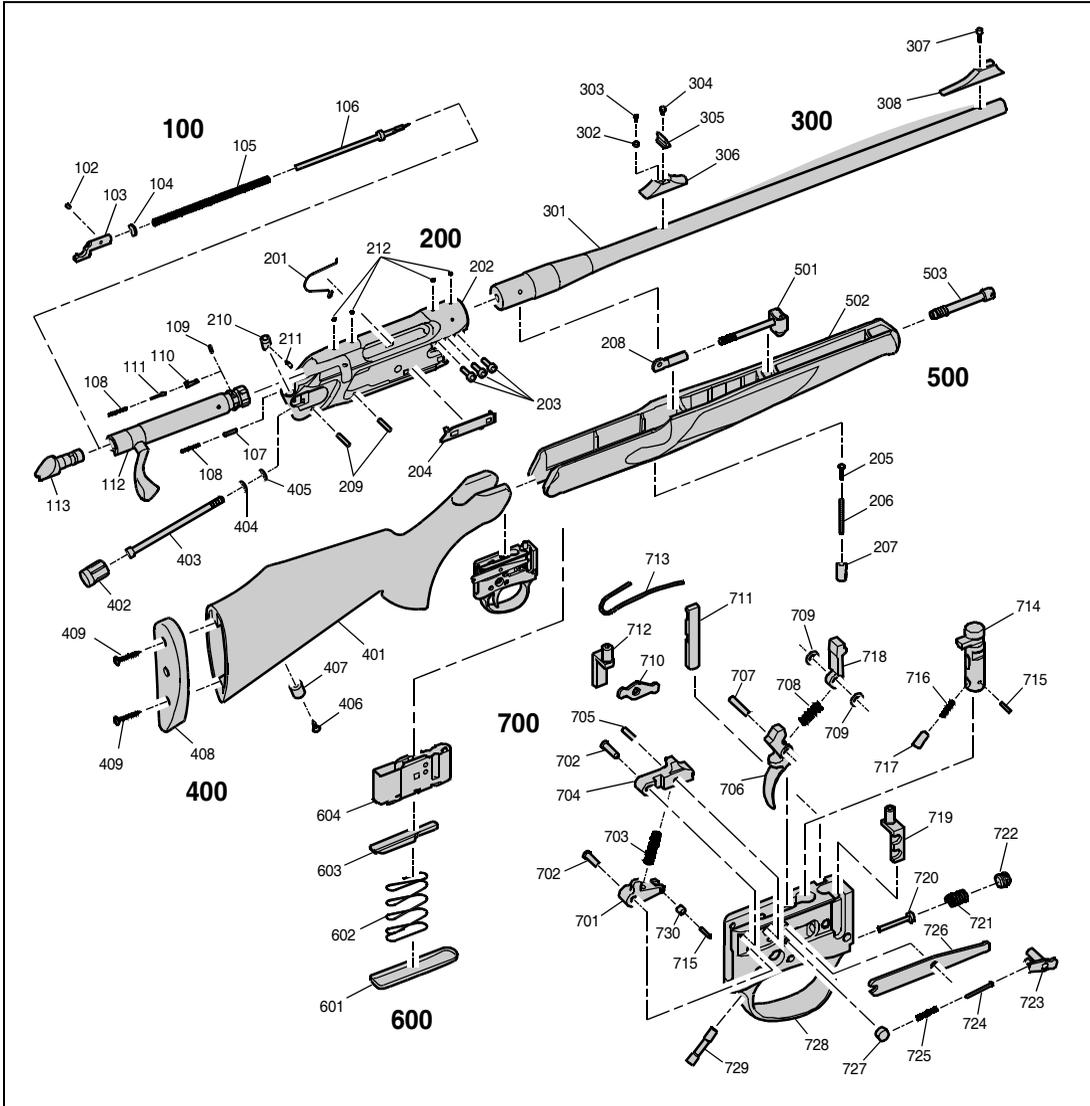
Рис. 22, Запасные части для модели S 202
