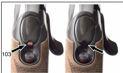
Abb. 8, Spannanzeige 103 der Kammer (links: gespannt, rechts: entspannt)
