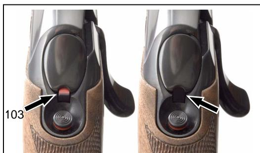
Fig. 8, Indicatore 103 del manubrio (a sinistra in tensione, a destra no)
