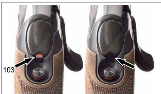
Рис. 8, Индикатор взведения 103 затвора каморы (слева: взведен, справа: отпущен)
