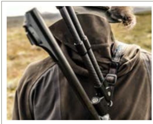
Das Allerbeste aber: Mit einem Knopfdruck ist das kleine Leichtgewicht beigeklappt und kann arretiert an der Waffe getragen werden. Ebenso kann das Carbon-Zweibein per Knopfdruck komplett vom Vorderschaft gelöst und im Rucksack verstaut werden.
