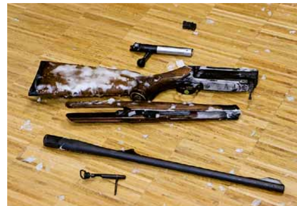
Mit Wasser besprüht und tiefgefroren. Trotzdem sind sowohl das Zerlegen als auch die Schussabgabe möglich.
