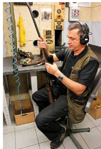
Überprüfung der Wiederholgenauigkeit mit Entnahme des Laufes und Abnahme des Zielfernrohres: Streukreis < 30 mm.
