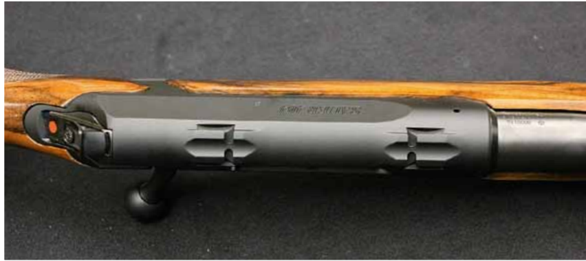
Die Sauer 404 ist für die „Sauer Universal-Montage“ vorbereitet. Diese gibt es als Schienen- und Ringmontagen für alle gängigen Mittelrohrdurchmesser.
